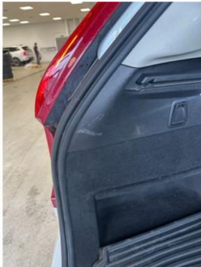
2.1 Noen riper på deksel i bagasjerom venstre side
