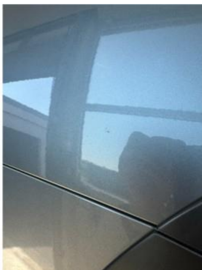
1.4 Antydning til ei lita rustboble i dør høyre bak
