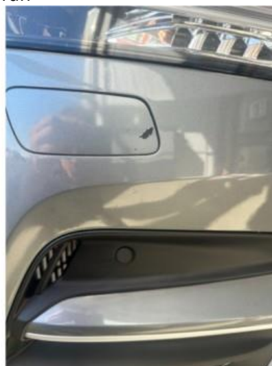
1.5 Liten lakkskade over spylerlokk høyre foran. Lakkeres forenklet
