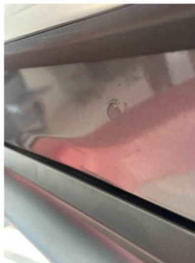
1.3 Liten bulk med lakkskade på dør under list venstre foran
