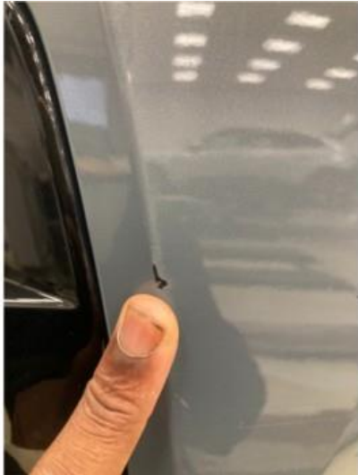
1.1 Lite hakk i fanger venstre foran. Lakkeres forenklet
