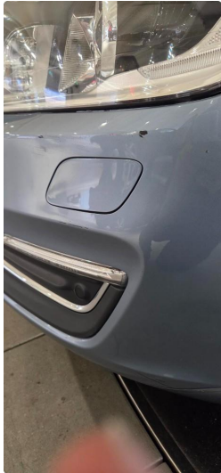
1.1 Noen små lakkskader i fanger venstre foran. Lakkeres forenklet
