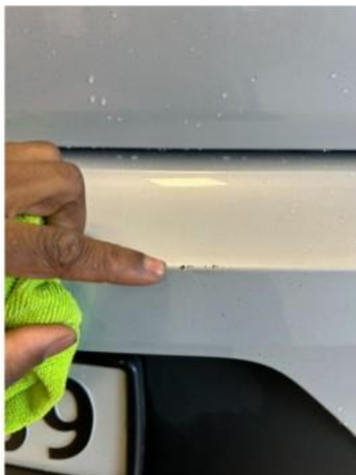
1.4 Noen riper/hakk i fanger bak. Lakkeres forenklet
