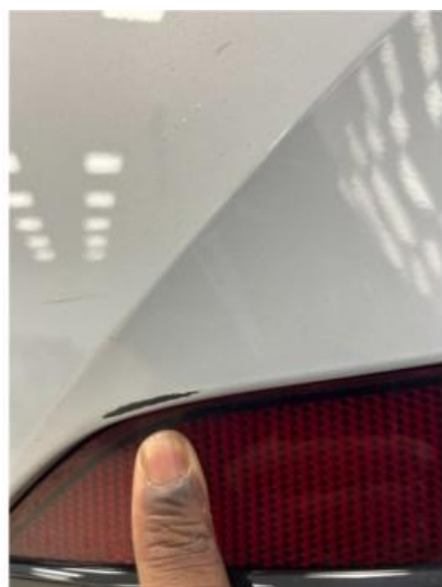
1.4 Noen riper/hakk i fanger bak. Lakkeres forenklet
