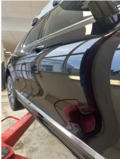
1.1 Små riper i dør høyre foran. Dempes med rubbing og polering
