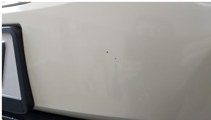
1.4 Noen steinsprut i fanger foran
