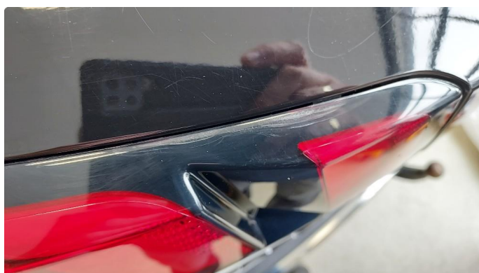
2.1 Litt krakelering på plast i lys bak
