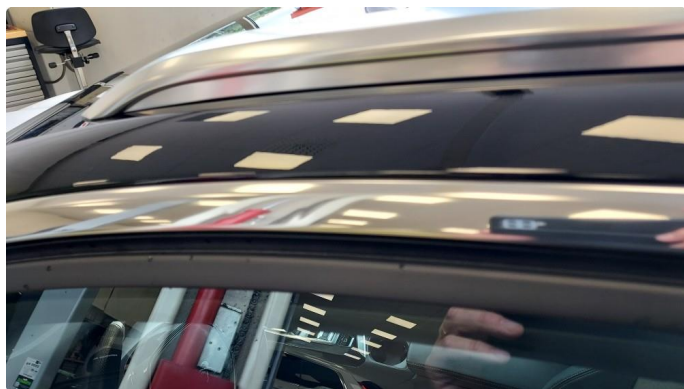
1.1 2 små bulker i chromlist på venstre framdør over vindu.
