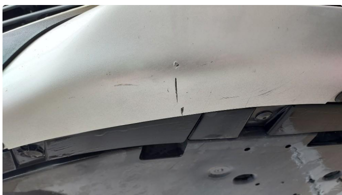
1.5 Ubetydelig oppripet på underside av fanger foran
