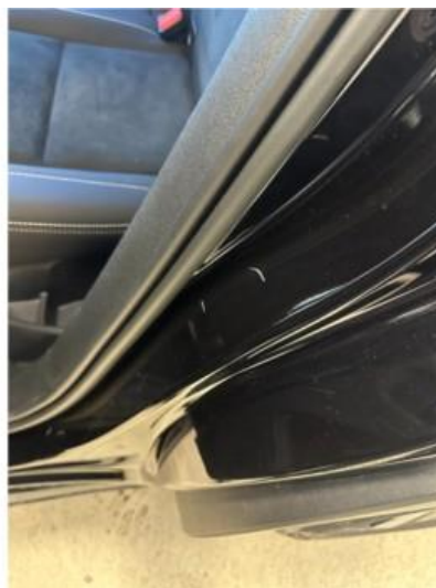
1.2 Ripe i døråpning venstre bak. Vil bli lakkert forenklet
