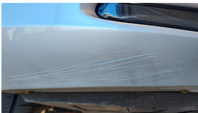
1.3 Litt oppripet på underside av fanger foran
