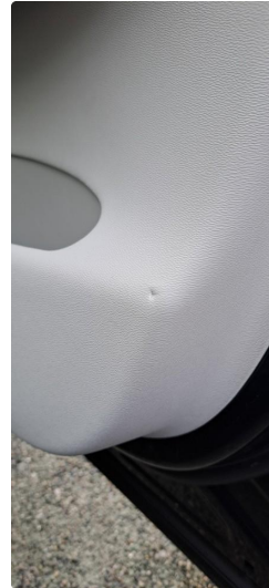
2.1 Lite merke i dørtrekk høyre foran
