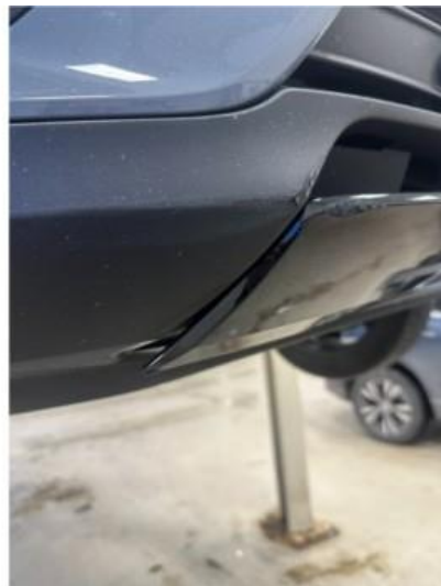
1.4 Små hakk i nedre del av fanger høyre foran
