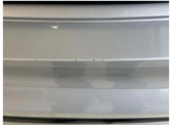
1.2 Små hakk i lastesone fanger bak. Lakkeres forenklet
