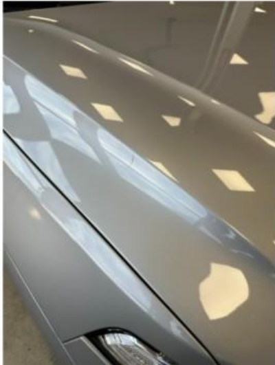
1.1 Lita ripe i panser. Dempes med rubbing og polering
