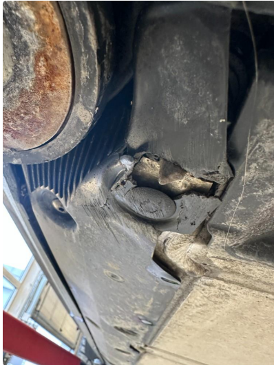
1.1 Noen sprekker i beskyttelsesplate under bilen
