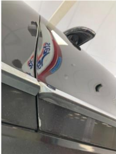
1.1 Litt lakkflass nede på dør venstre foran. Lakkeres forenklet
