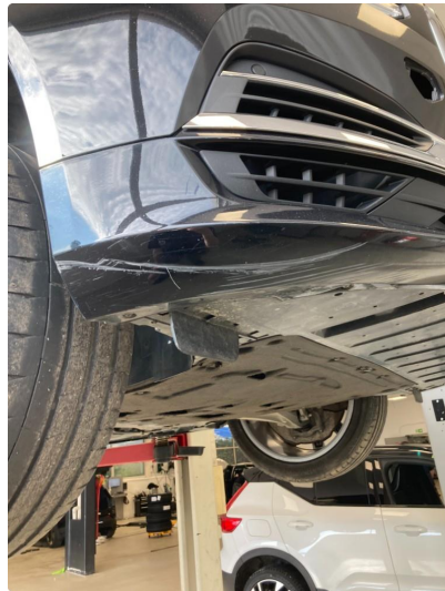
1.5 Noen riper i underkant av fanger foran
