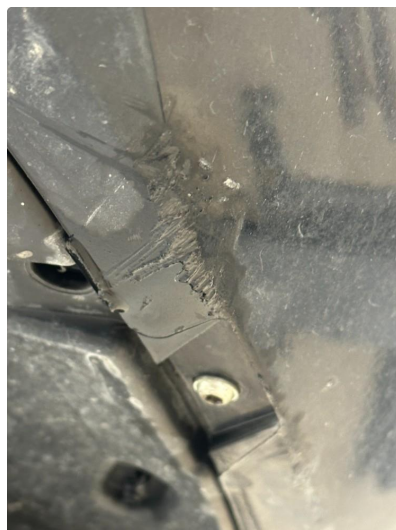
1.2 Litt oppripet på underside av fanger foran
