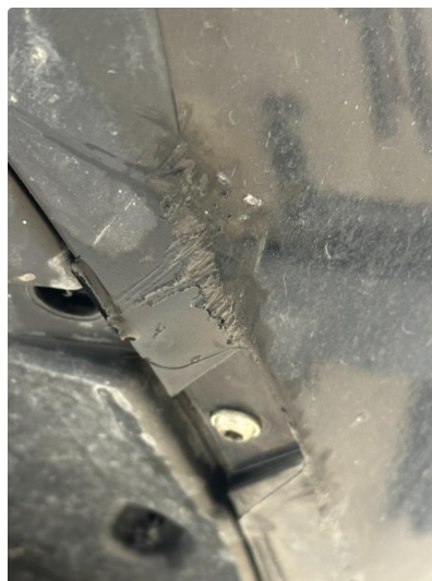
1.2 Litt oppripet på underside av fanger foran
