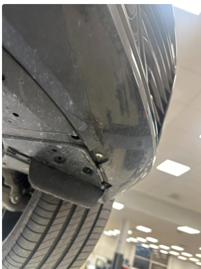
1.2 Litt oppripet på underside av fanger foran
