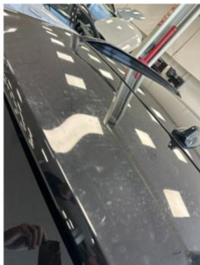
1.1 Litt oppriperet oppe på bakluke. Dempes med rubbing og polering
