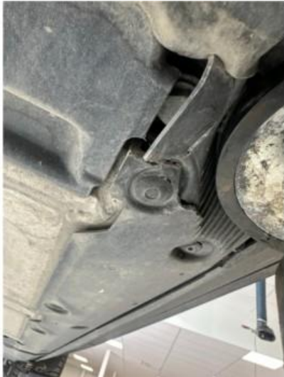
1.1 Ubetydelig sprekk i beskyttelsesplate under bil. Normal slitasje
