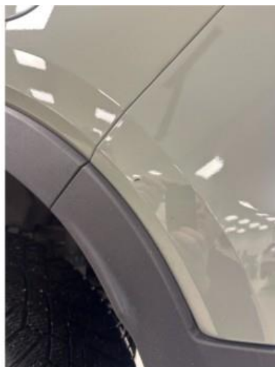
1.3 Liten steinsprut i fanger venstre bak
