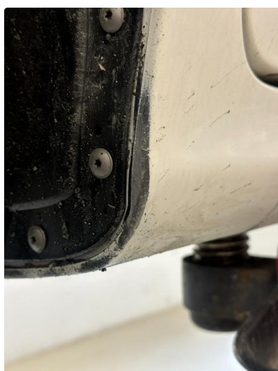
1.3 Litt matt/slitt lakk på kanaler under dører begge sider
