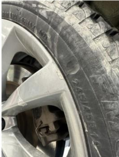
1.1 Liten dekkskade på ett vinterdekk + en liten skade på felg. Normal slitajse
