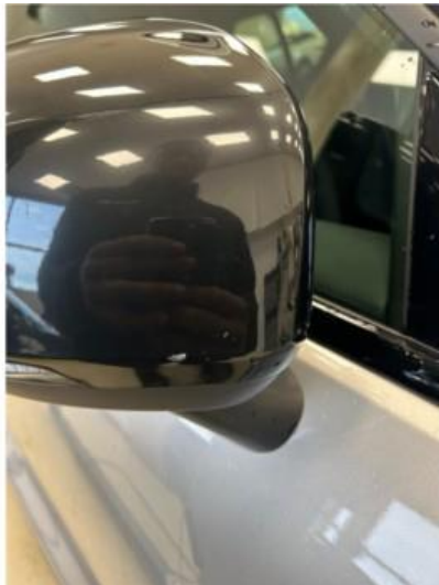
1.1 Liten steinsprang i speilhus høyre side. Lakkeres forenklet
