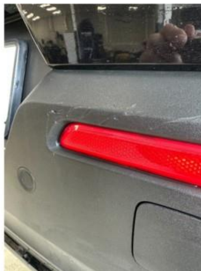
1.2 Noen riper i fanger høyre bak
