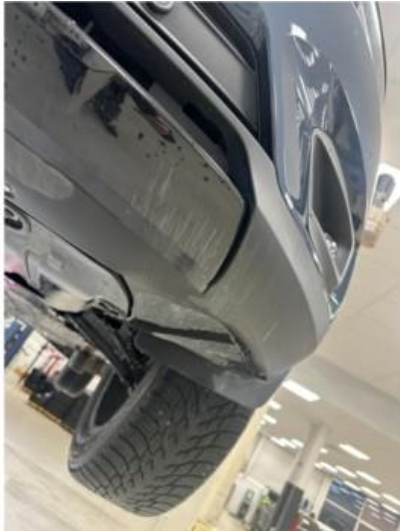
1.1 Litt oppripet på underside av fanger venstre foran
