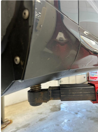
1.1 Noe matt/slitt lakk på kanaler begge sider. Normal slitajse
