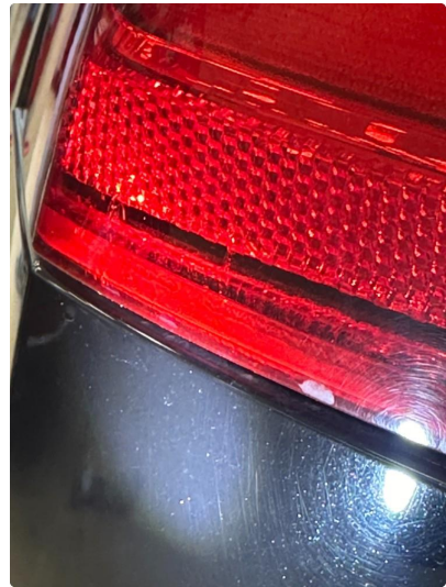
2.1 Litt krakelering i plast på baklykt venstre side
