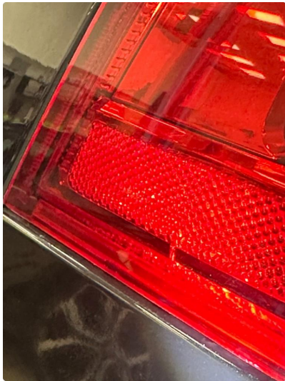
2.1 Litt krakelering i plast på baklykt venstre side
