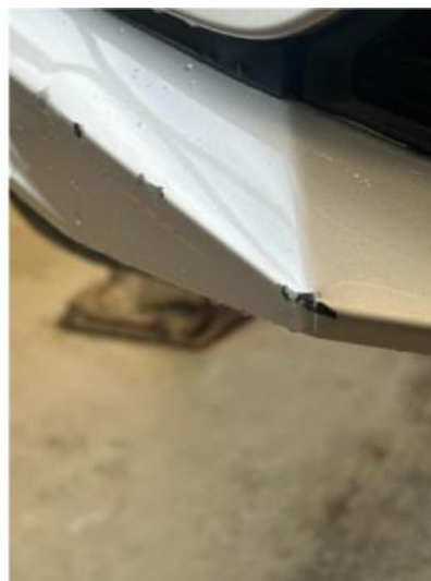
1.2 Noe hakk/riper i nedre del av fanger foran
