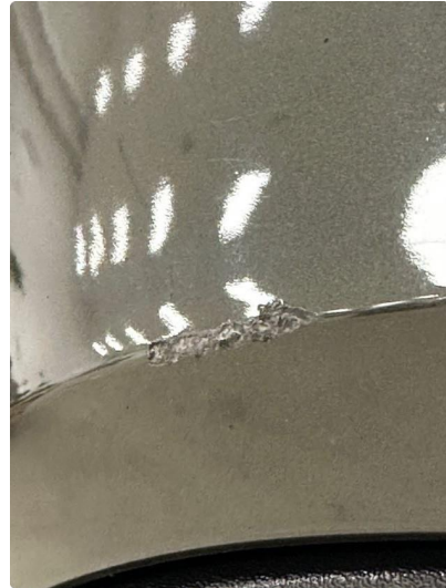
1.2 Noen små på bilens km riper/hakk i fanger bak. Normal slitasje med tank
