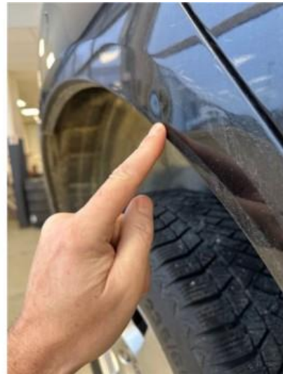
1.4 Noen p.bulker i skjerm høyre bak
