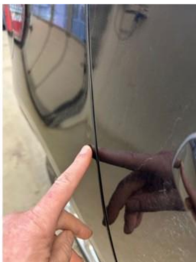
1.3 Noen p.bulker i skjerm høyre bak
