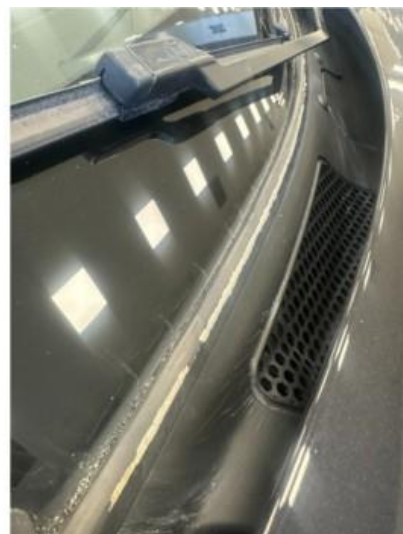
1.3 Litt slitt list på nedre del av frontrute
