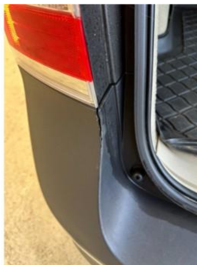
1.4 Liten sprekk i fanger venstre bak
