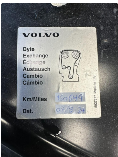
2.1 Registerreim/kjede byttet 07.08.2024 på 160 649 km
