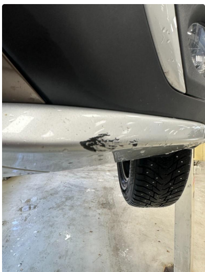
1.3 Litt oppripet på nedre del av fanger venstre foran
