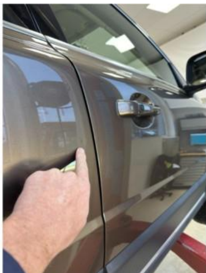
1.1 P. bulk i dør høyre bak
