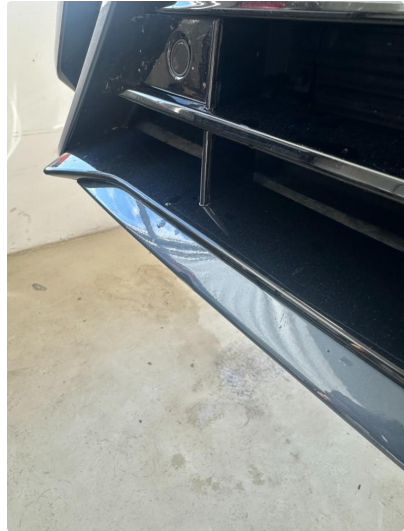
1.1 Svak liten bulk i nedre del av fanger foran
