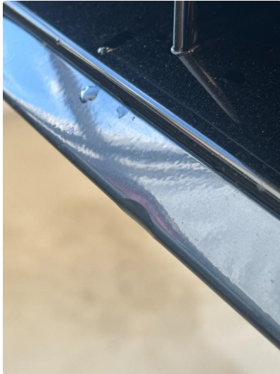
1.1 Svak liten bulk i nedre del av fanger foran
