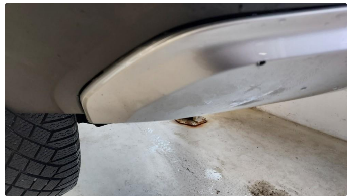
1.2 Noen lakksår i fanger bak, venstre side
