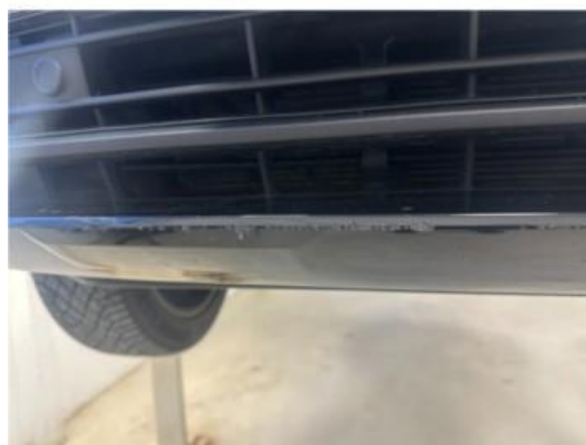
1.2 Litt oppripet på underside av fanger foran
