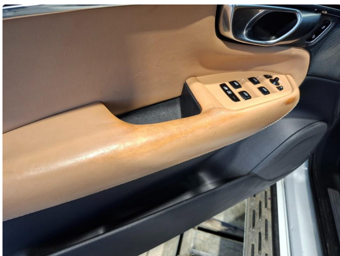
2.1 Noe slitt dørtrekk venstre foran
