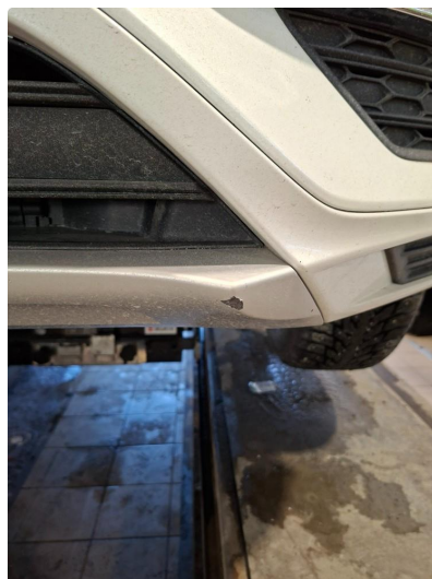
1.1 Små hakk i nedre del av fanger foran
