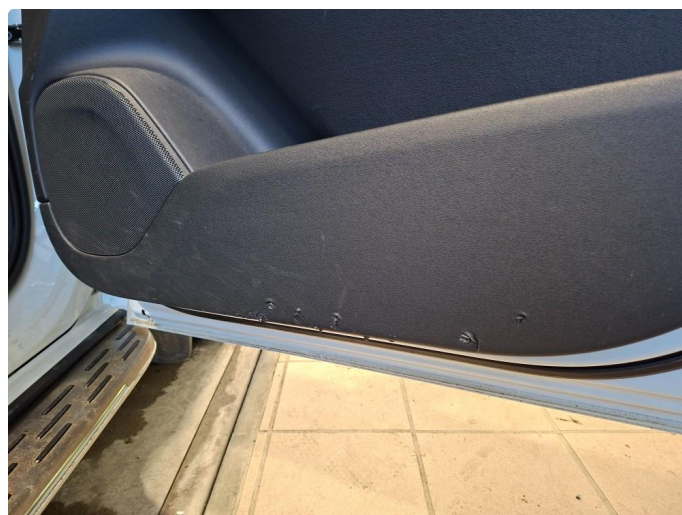
2.2 Noen hakk i dørtrekk høyre foran
