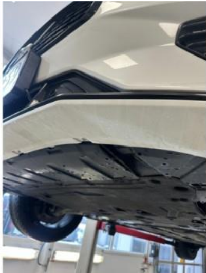
1.1 Litt oppripet på underside av fanger foran. Normal slitasje
