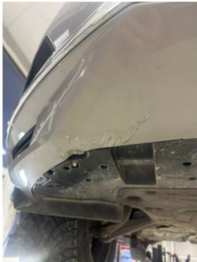
1.1 Litt oppripet på underside av fanger foran
