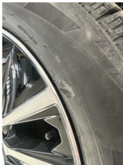
1.2 Liten dekkskade på ett vinterdekk. Godkjent
