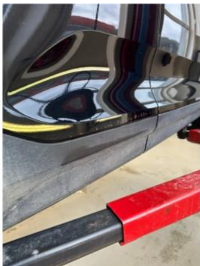
1.1 Noen riper i nedkant dør. Dempes med rubbing og polering
