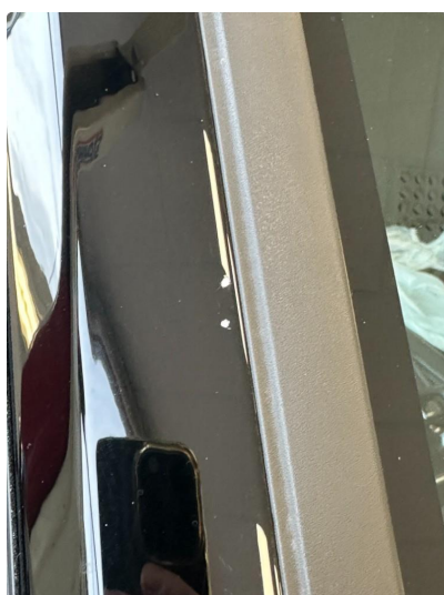
1.3 Liten steinsprut A-pillar høyre side. Flekklakkeres
