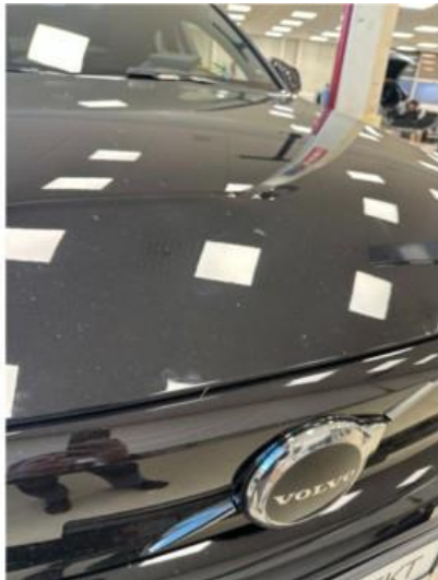
1.2 Noen steinsprut i panser. Lakkeres forenklet
