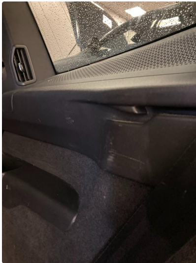
2.1 Noen riper i deksel bagasjerom høyre side
