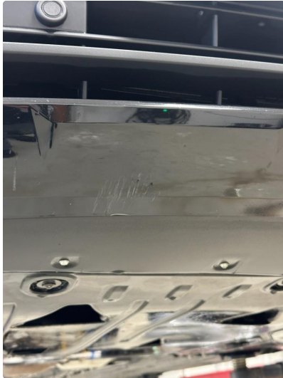
1.1 Litt oppripet på underside av fanger foran
