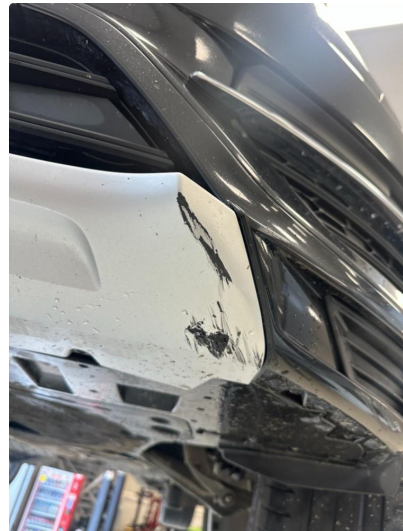
1.3 Skrubbskader underkant av fanger foran. Normalt med tanke på bilens km
