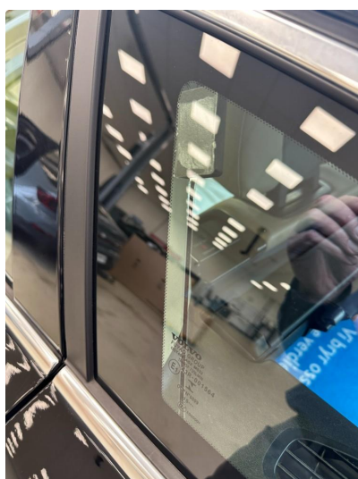
2.1 Ettermontert DAB+ løsning med variabel dekning
