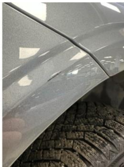
1.3 Lakkskade i fanger venstre foran. Lakkeres forenklet
