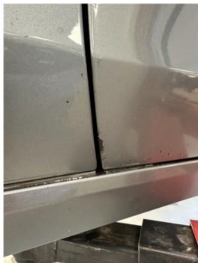
1.1 Noe lakkflass i dør venstre foran. Pusses og lakkeres forenklet
