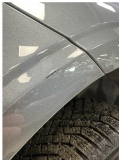
1.3 Lakkskade i fanger venstre foran. Lakkeres forenklet
