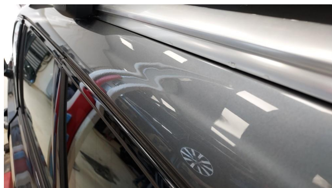
1.5 Liten svak bulk på tak venstre side over vindu 3
