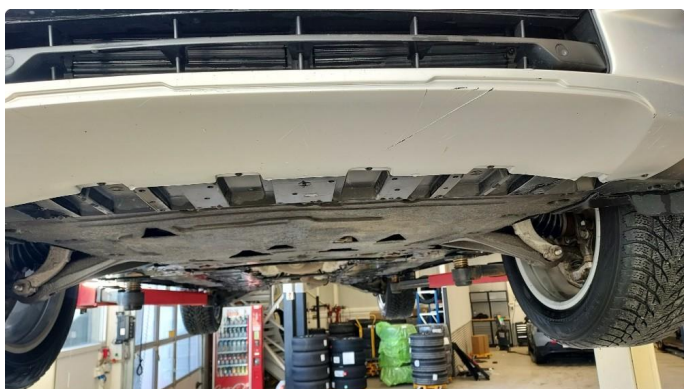
1.4 Litt oppripet på underside av fanger foran. Normal slitasje
